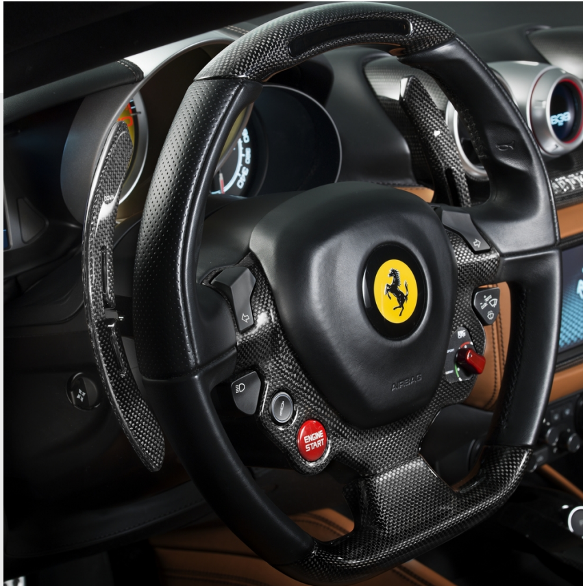
F1 赛车换挡拨片, 采用哑光碳纤维
