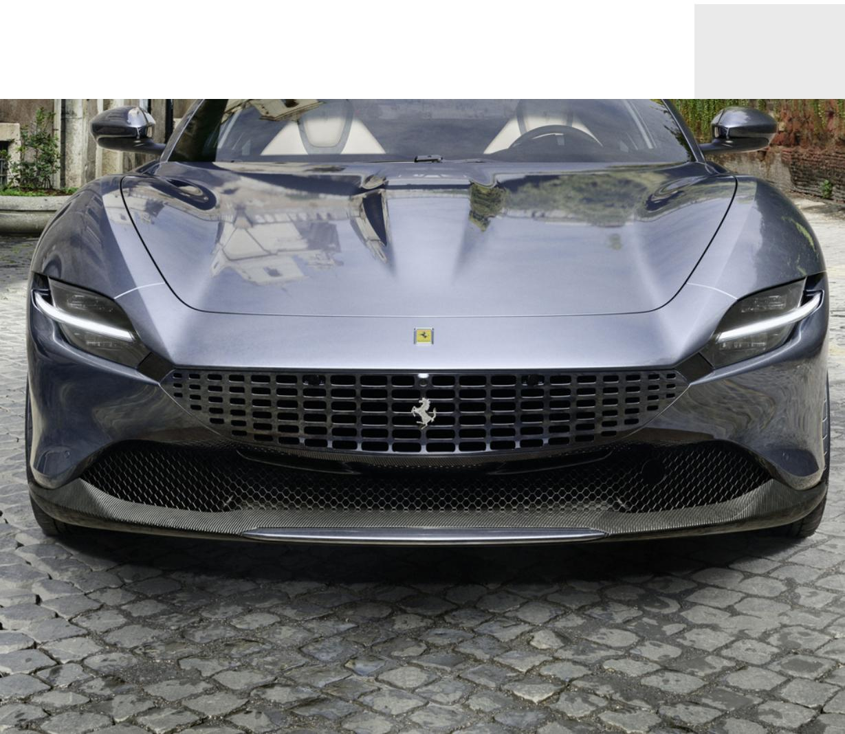
碳纤维前扰流板采用先进的流体动力学建模技术开发而成，并且在风洞中经过锤炼，以优化车身底板的空气动力特性，对车辆的整体空气动力性能发挥至关重要的作用，同时为客户提供了对其车辆外观进行个性化设计的机会。
