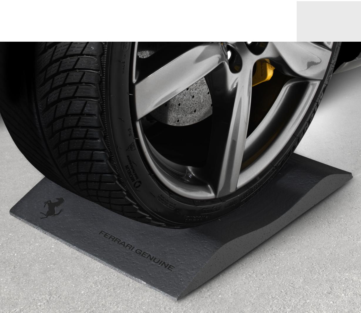
这套防椭圆支架旨在防止轮胎上形成瘪胎，既可以在车辆闲置期间使用，也可以在车库中始终保持汽车远离地面。
