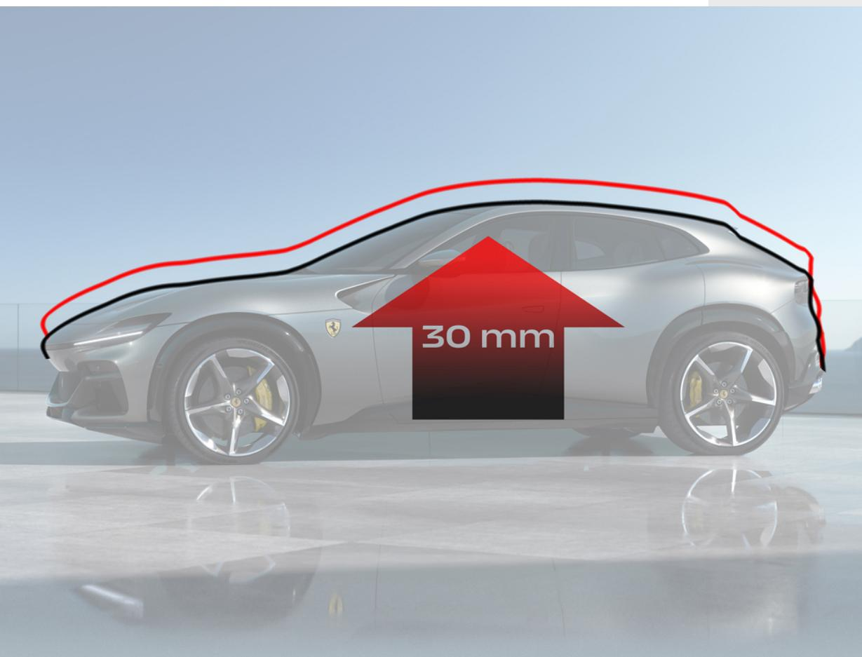
为了确保所有驾驶条件下的最大实用性，Ferrari Genuine 提供了一个系统，该系统有助于在颠簸或坡道上驾驶并保持车辆的完整性。升力作用在车辆的四个减震器上，使其能够升高约 30 毫米。
