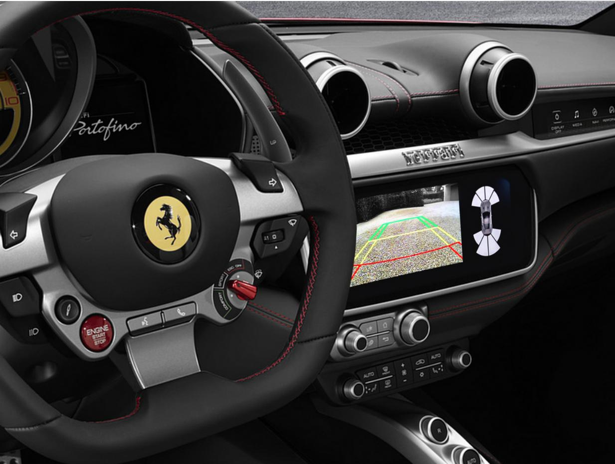
Ferrari 驻车摄像机系统能够帮助防止在驻车时意外撞到障碍物。包含前后摄像机的套件在仪表板上显示必要的信息，由于增加了驻车传感器和实用的虚拟网格，还可在挪车时为驾驶员提供辅助。
