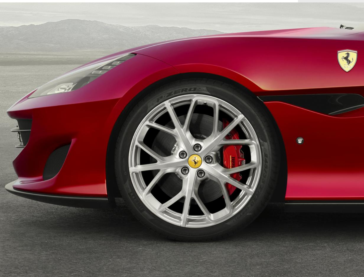
由 Ferrari 造型设计中心专为 Ferrari Genuine 而设计的 20 英寸锻造车轮将独特的设计与高度创新的技术结合在一起，从而凸显了车辆的线条。锻造工艺显著减轻了车辆总重，提升了驾驶感并且保证了更迅速的响应。根据您的选择的是双色调金刚石亮光轮辐还是独特的油漆饰面，这些 20 英寸锻造车轮将赋予车辆更加运动或更加优雅的外观。
