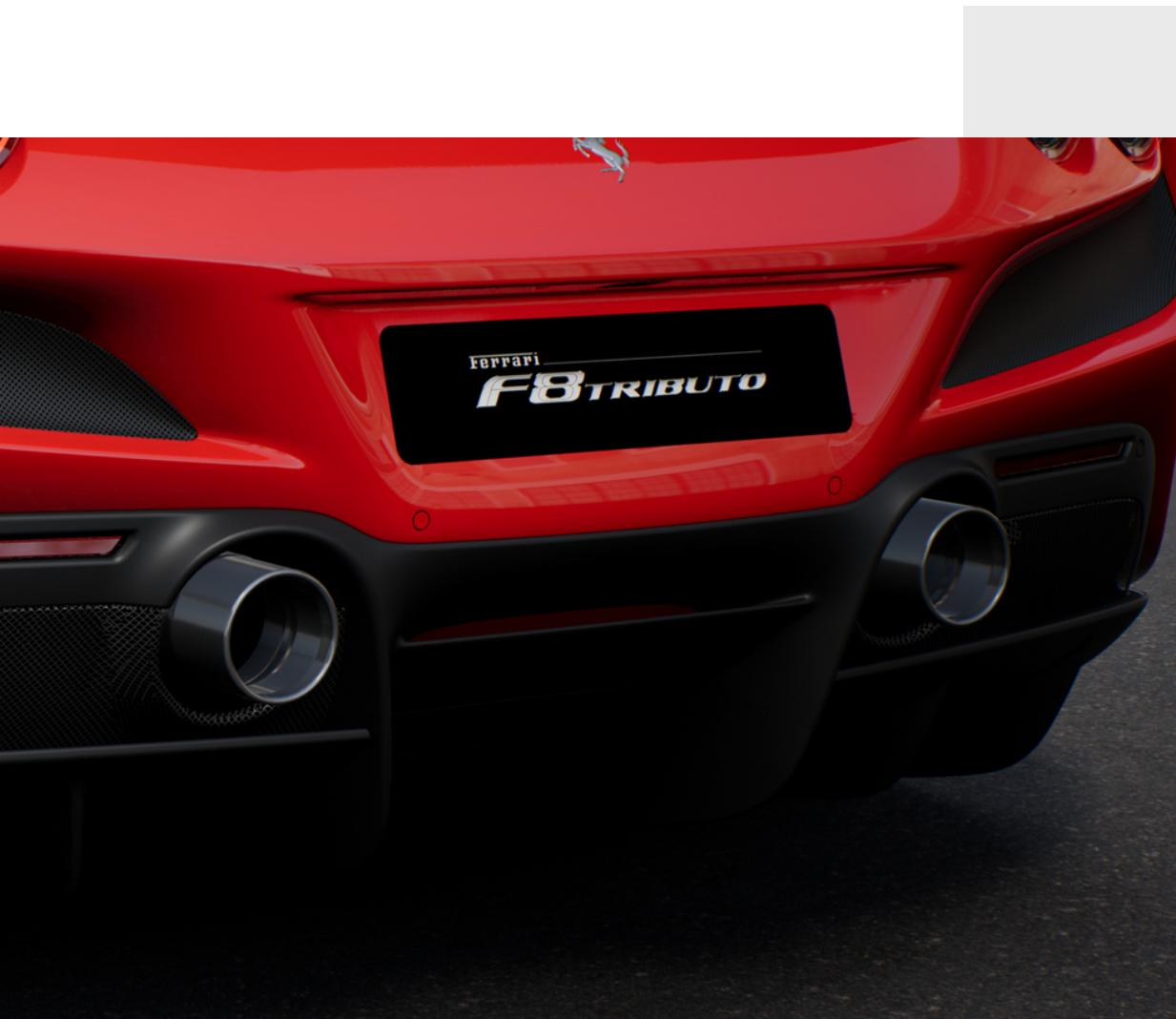
钛合金尾管末端的设计基础与标准尾管末端相同，但重量却比后者轻 50%，并且具有帮助其保持相同外观的表面光洁度。使用这种技术先进材料能够最大限度地保证对外部因素的抵抗力，同时也是 Ferrari 不断追求产品改进的完美例证。
