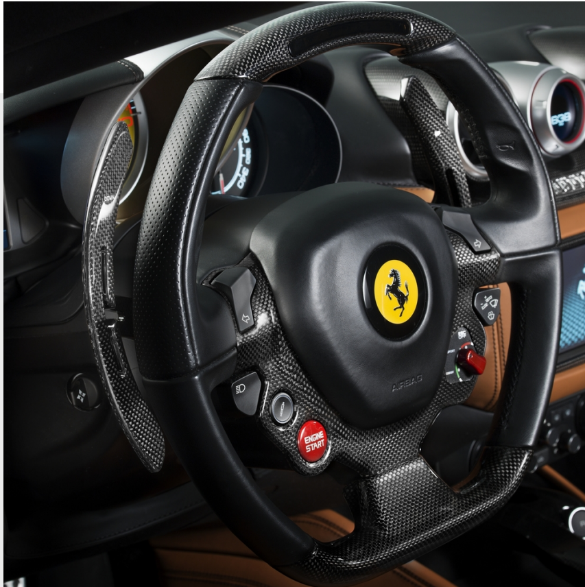
F1 赛车换挡拨片, 采用哑光碳纤维
