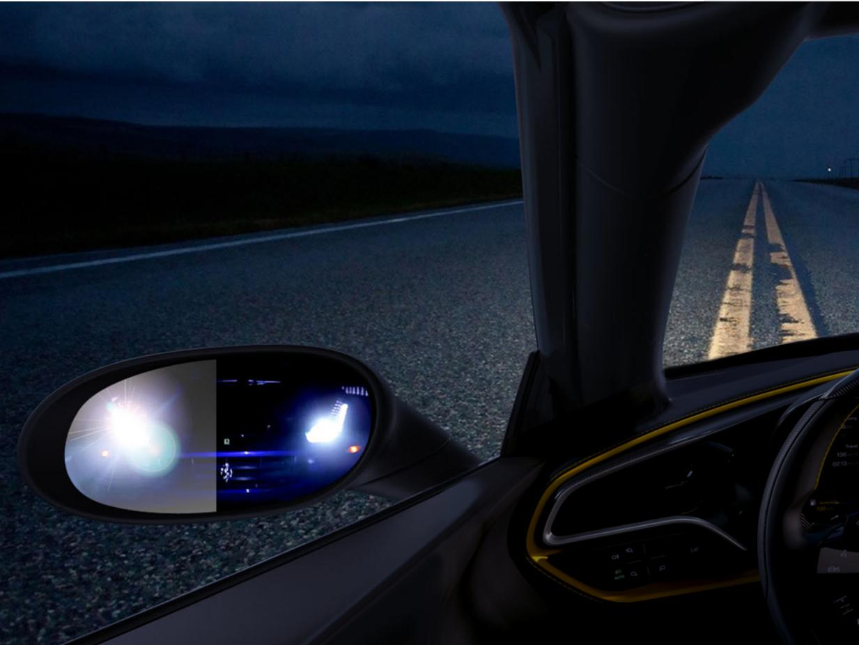
电致变色后视镜能够为驾驶员有效地减少反射眩光。该后视镜采用特殊的电致变色技术，可根据投射到其上的光线亮度迅速自动变暗。
