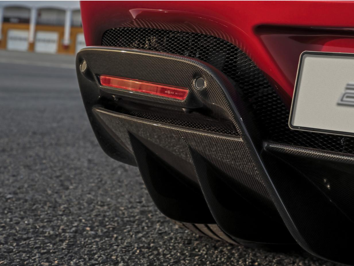
这款碳纤维扩散板设计用于增加后下压力并帮助从车身底部疏散空气，在强调车辆风格的同时还能执行精确的空气动力功能，并且有助于减轻车重。
