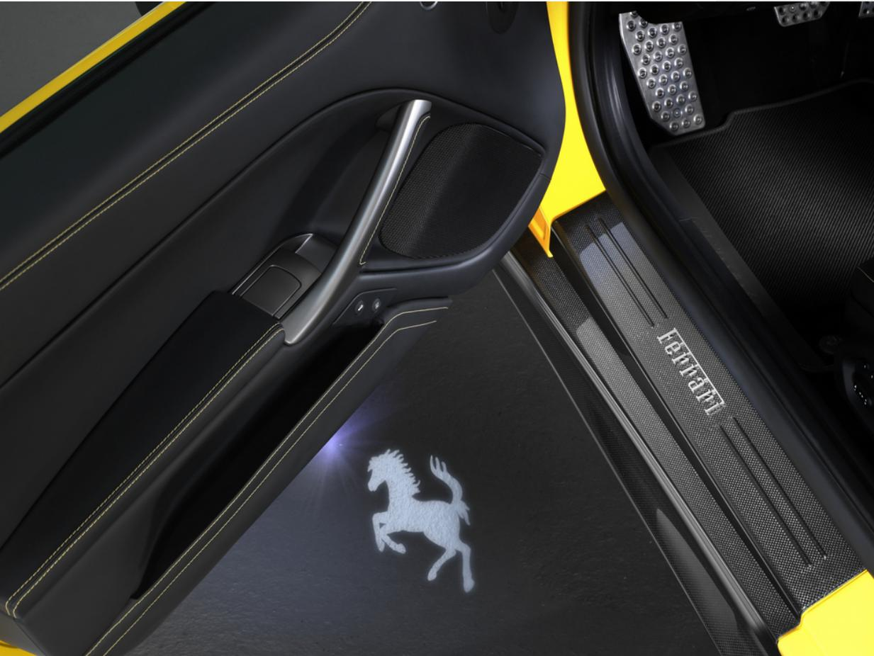
车门下方照明套件为车主提供了凸显其 Ferrari 爱车另一项与众不同的时尚特性的机会。该套件包括两个车灯组件和 4 组专用灯罩，用于在车门打开时将车辆标志或跃马图案投射到车门下方的地面上。
