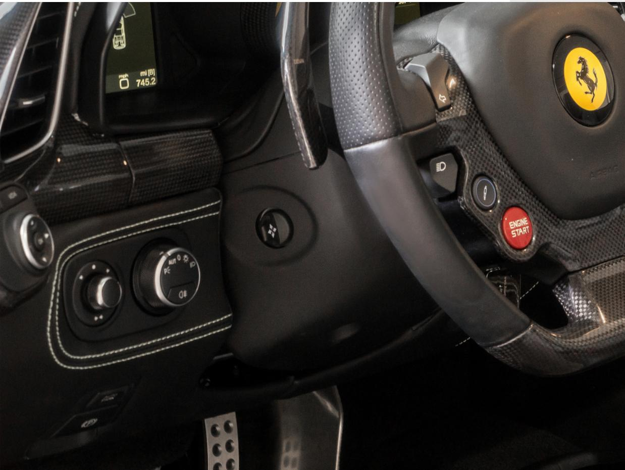
Ferrari 为其客户提供由两台电动机操作的电动调节式上下伸缩 (Reach & Rake) 的转向柱，即使车辆正在行驶，也能为您提供更高级别的驾驶舒适性并保证完全的安全性，而无需将视线离开路面。当发动机起动时，转向柱会自动朝驾驶员方向移至上次记忆的位置；而当发动机关闭时，它又返回至最大倾斜和伸缩位置，以便更方便地进出车辆。
