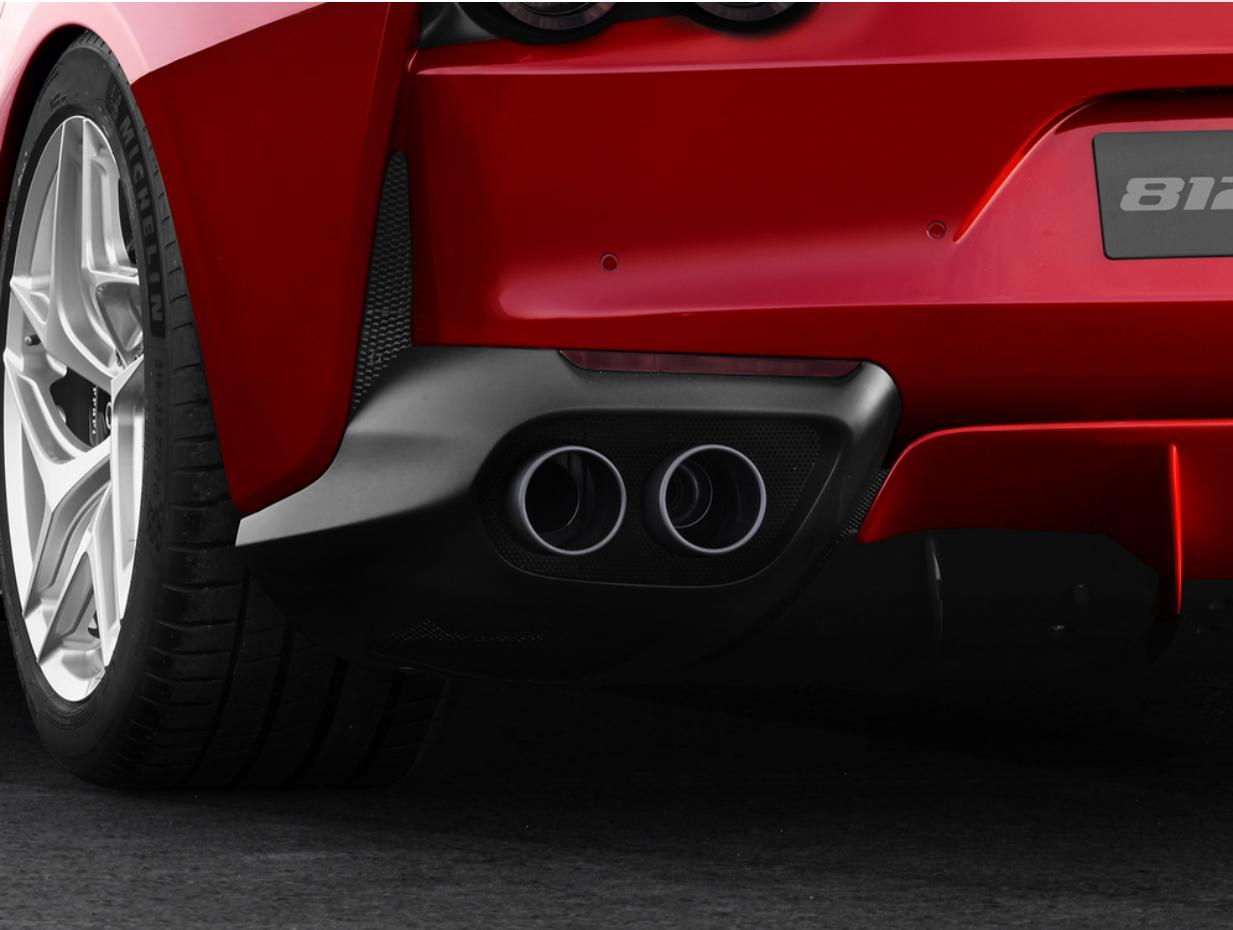
钛合金尾管末端的设计基础与标准尾管末端相同，但重量却比后者轻 50%，并且具有帮助其保持相同外观的表面光洁度。使用这种技术先进材料能够最大限度地保证对外部因素的抵抗力，同时也是 Ferrari 不断追求产品改进的完美例证。
