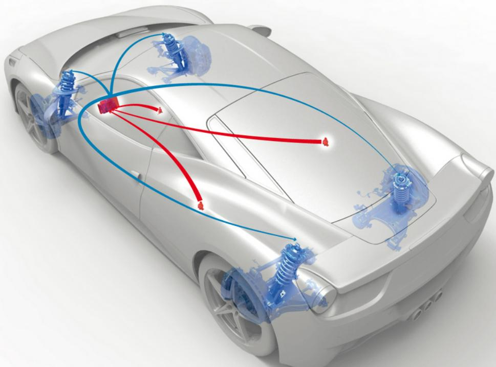
该 HS 套件推出了为增强车辆的运动特性以确保更加强烈的公路驾驶乐趣而开发的新成果。通过该套件推出的全新性能内容包括创新的磁流变减震器控制软件，该软件能够改进偏航/俯仰/侧倾阻尼效果并提高轮胎的性能，以提供更加运动的转向感。该控制功能在所有 Manettino 位置都有效，需要针对每个位置经过特定校准。
