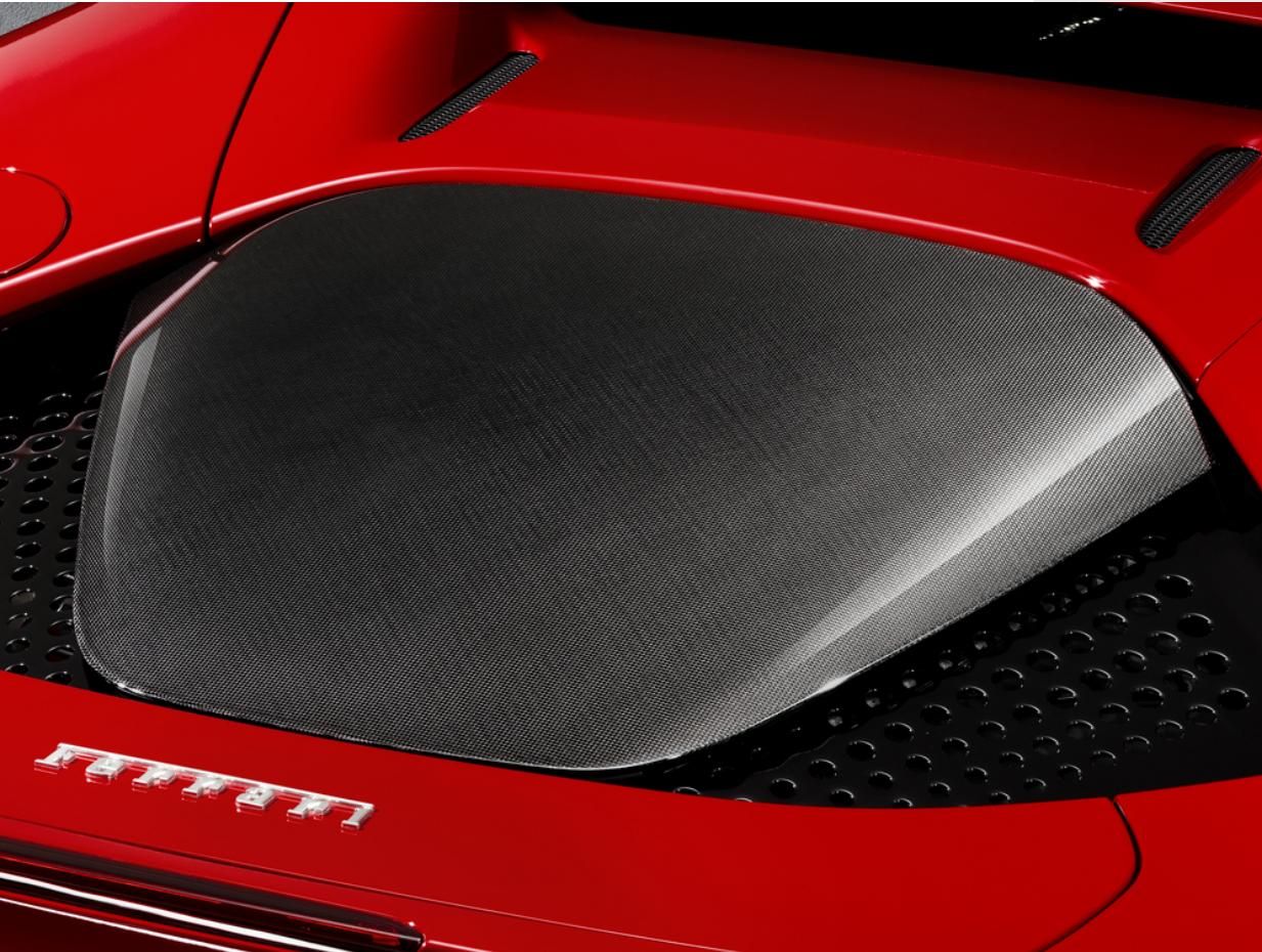
コンポーネントの重量を減らすために FerrariCentroStile によって設計されたカーボンファイバーエンジンコンパートメントカバーは、すべてハイテク素材で作られています。目に見えるカーボンファイバーと外側の光沢のある仕上げは、車にさらなる決意とスポーティさを与えます。
