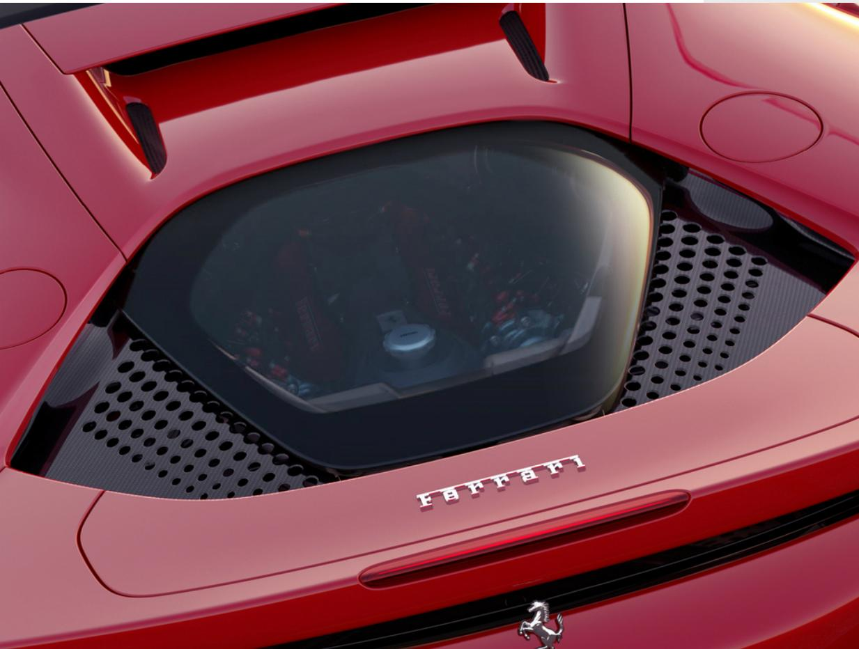
リアウィンドウのエンドエリアに取り付けられたカバーは、特定の形状を通じて、エンジンコンパートメントの正しい空気の流れを確保します。
