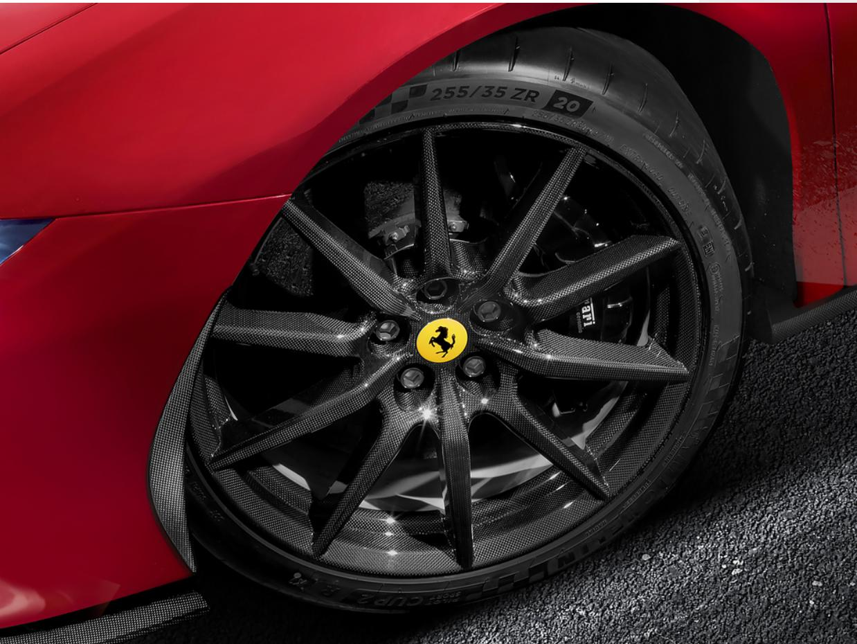
よりスポーティなモデルの場合、専用の20インチカーボンファイバー製ホイールを注文できます。
