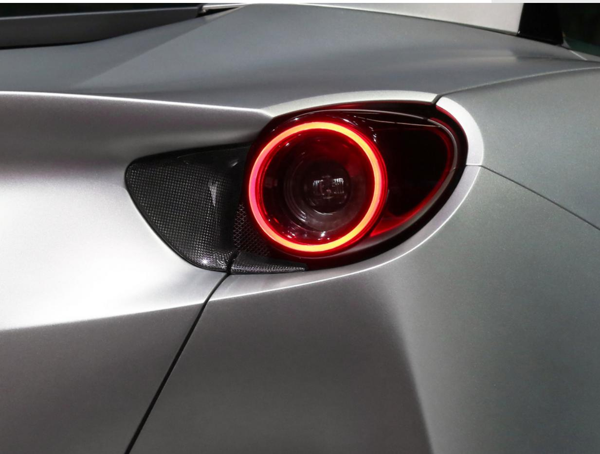
車のエンジンルームから空気を抽出するためのリアバンパーの2つの開口部は、超軽量で技術的に高度な素材であるカーボンファイバーバージョンに置き換えることができ、車の後部のグリットの増加に貢献します。
