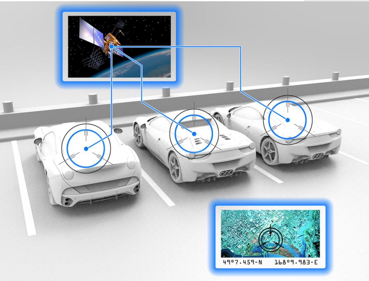
フェラーリ “GENUINE” サテライトアラームシステムには、ADR カード付きとなしの 2 つの仕様が用意されています。ADR カード付きシステムは、盗難防止システムを車両に装着する時にお客様にお渡しする個人カード（運転者自動識別）を検出して認可ドライバーを識別します。盗難時には、無音のアラーム信号を NavTrak コントロールセンターに送信して車両の位置を確認することができます。NavTrak は、コントロールセンターを通して 365 日 24 時間いつでも盗難車を追跡することができます。この盗難防止装置装着車は、ヨーロッパの 42 ヶ国で追跡が可能です。NavTrak システムは GSM 対応地域ならばどこでも使用できます。
