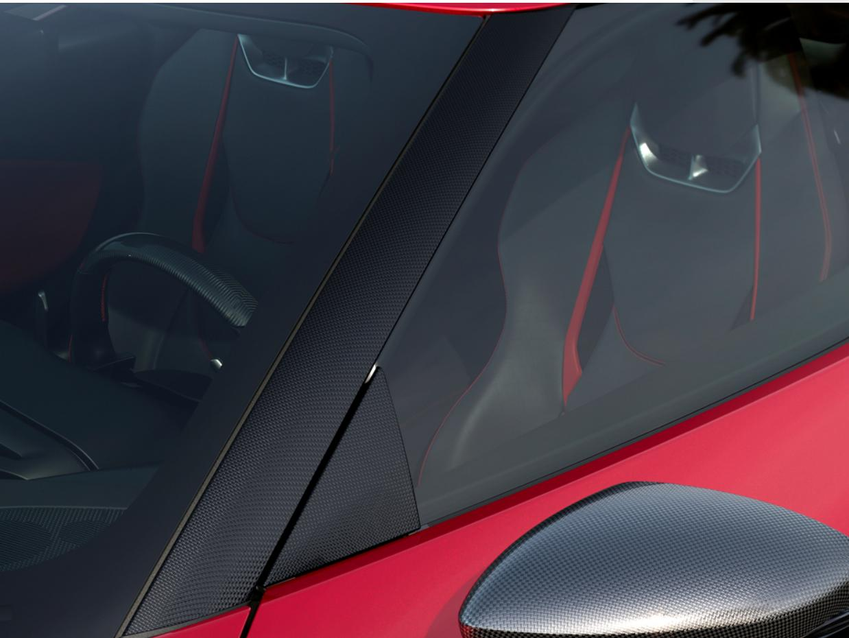
カタログアクセサリー専用に製作されたカーボンファイバー製のフロントピラーは、296GTBに独自性と排他性を与え、全体的な重量の軽減に貢献します。カーボンファイバーは、特別なダーククリアで塗装され、車両のガラス面と完璧に調和し、スポーティなキャラクターを引き立てる同時に、独自性を加えます。
