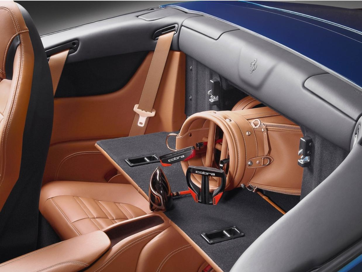
フェラーリ “GENUINE” アクセサリーでは、50 : 50 分割可倒式リアシートをご用意しています。これによって、必要に応じて片側または両方のリアシートを倒して California T のラゲッジスペースを変更することができます。
