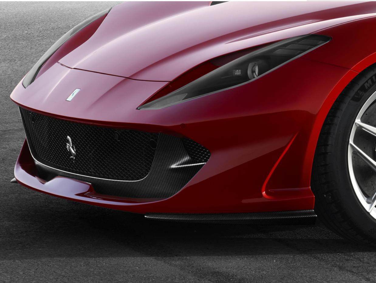
先進の流体力学におけるモデリングテクノロジーを用いて開発されたアイテムです。アンダーボディのエアロダイナミクスを最適化すべく風洞実験によってその性能に磨きがかけられたフロントspoイラーは、総合的な空力性能を大幅に改善するだけでなく、お車の外見をカスタマイズするうえでも効果を発揮します。
