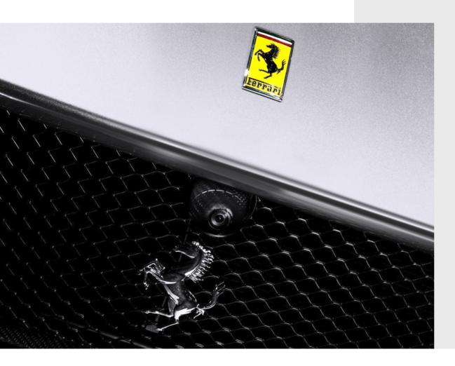
レースの美学をさらに高めるために、フェラーリ純正では、プラスチック製のフロントカメラカバーに代わるこのカーボンカバーを提供しています。
