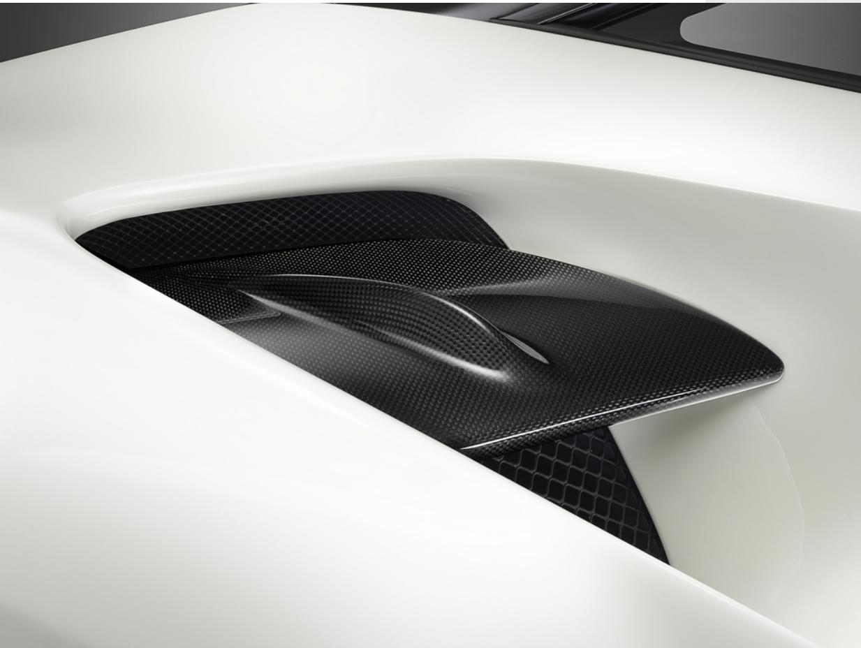
サイドエアインテークに取り付けられたスプリッターは、車のスポーティなラインを特徴付ける象徴的な要素であり、最大のエンジン性能を確保するためにエアフローを分離します。 Ferrari Genuineは、Centro Stile Ferrariがアクセサリーカタログ専用に設計したカーボンファイバーバージョンを提供しています。 追加の中央フィンと高品質の素材により、これらのフロースプリッターは車にユニークなタッチを保証し、決定的で排他的な外観を提供します。
