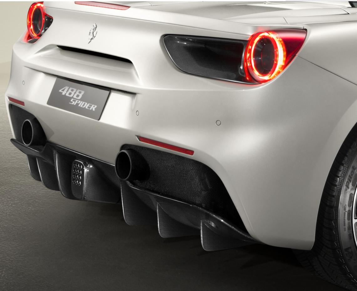
リアのダウンフォースを高めるとともに、アンダーボディからの空気の排出を促進させます。カーボンファイバー ディフューザーは、車両のスタイリングを引き立てるのはもちろんのこと、エアロダイナミクスの精度を高めつつ、軽量化にも寄与します。
