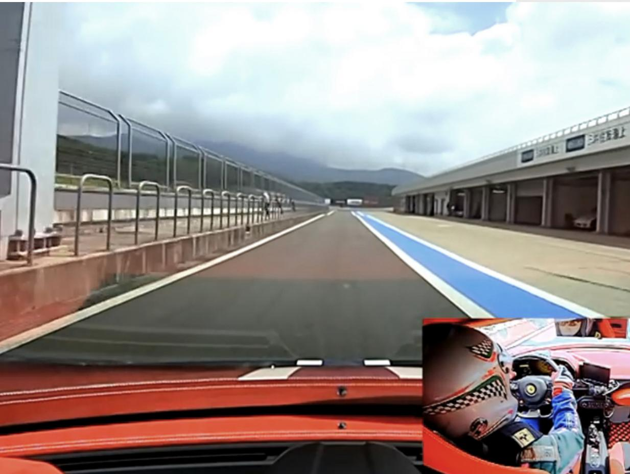
サーキットカメラは、フェラーリテレメトリー・キットに追加して注文するオプションのアクセサリーです。サーキットとドライバーゾーンの両方を撮影できる車内の位置にこれらのカメラを取り付けて走行体験を記録し、後でパフォーマンスを高解像度ビデオで見直して、走行ライン、ブレーキングポイント、およびドライビングテクニックを分析することができます。
