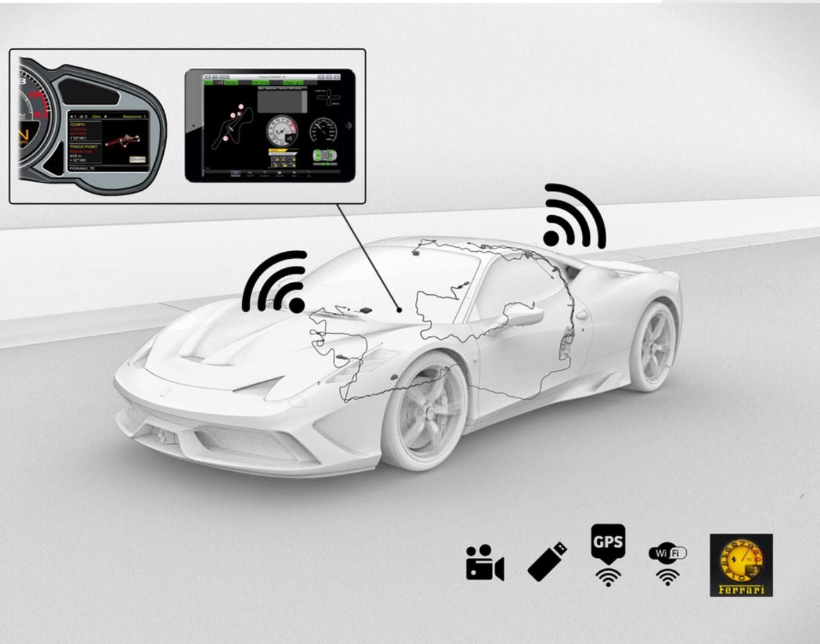
フェラーリテレメトリーキット（マルチメディアシステムに統合）を使用すれば、車両位置のモニターに加え、各サーキットセッションにおけるパフォーマンスデータの記録と分析が可能になります。記録された主要パラメーターは、ダッシュボード、iPad デバイス、または PC に直接表示することができます。
