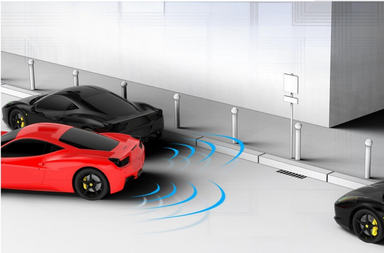
フェラーリが開発したパーキングセンサーは、車両の前方または後方に障害物が存在することを警告音で知らせるとともに、障害物との距離に関する情報をドライバーに提供します。システムが発する警告音と表示により、ドライバーは駐車時の接触を避けることが可能になります。
