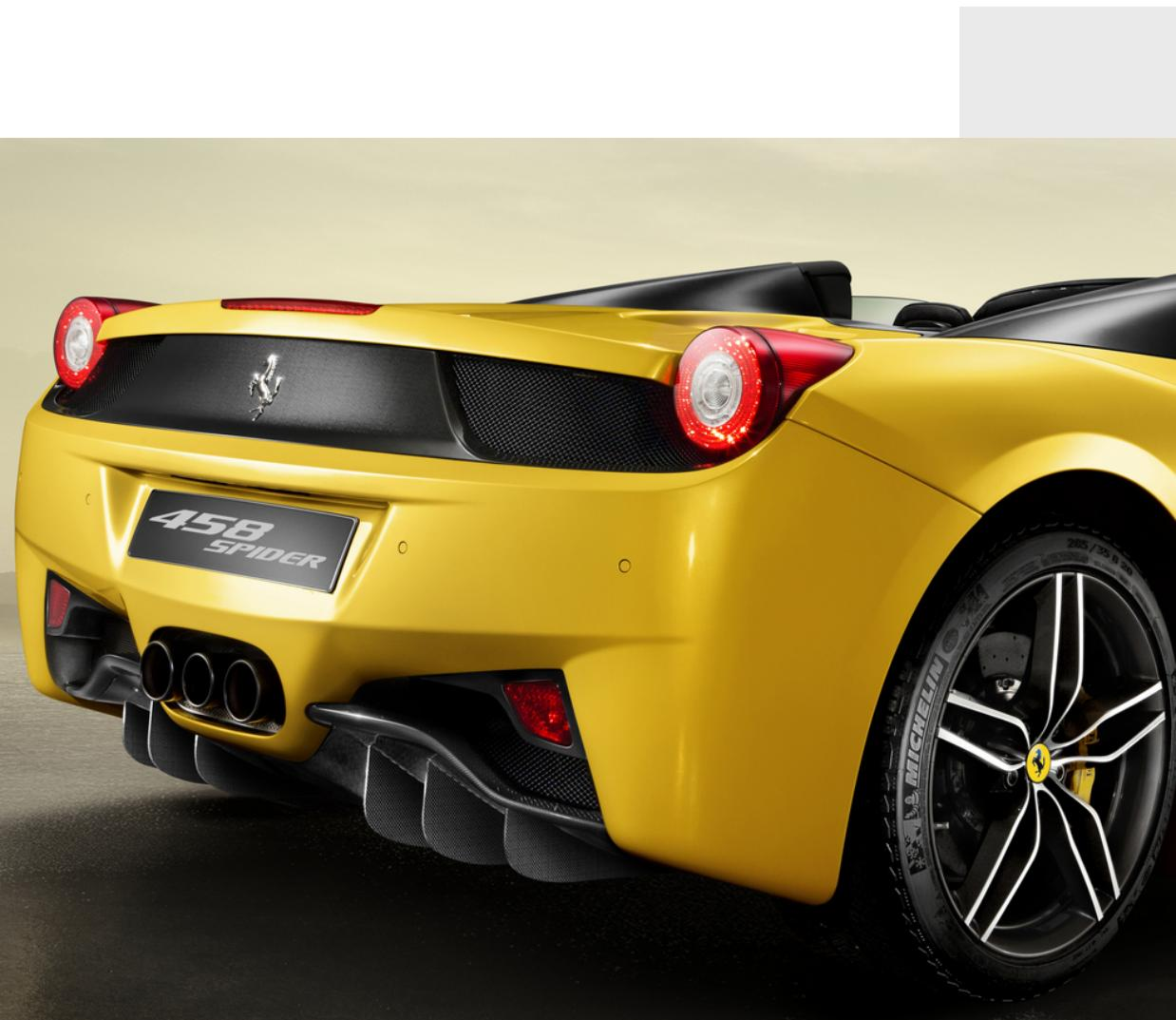
リアのダウンフォースを高めるとともに、アンダーボディからの空気の排出を促進させます。カーボンファイバー ディフューザーは、車両のスタイリングを引き立てるのはもちろんのこと、エアロダイナミクスの精度を高めつつ、軽量化にも寄与します。
