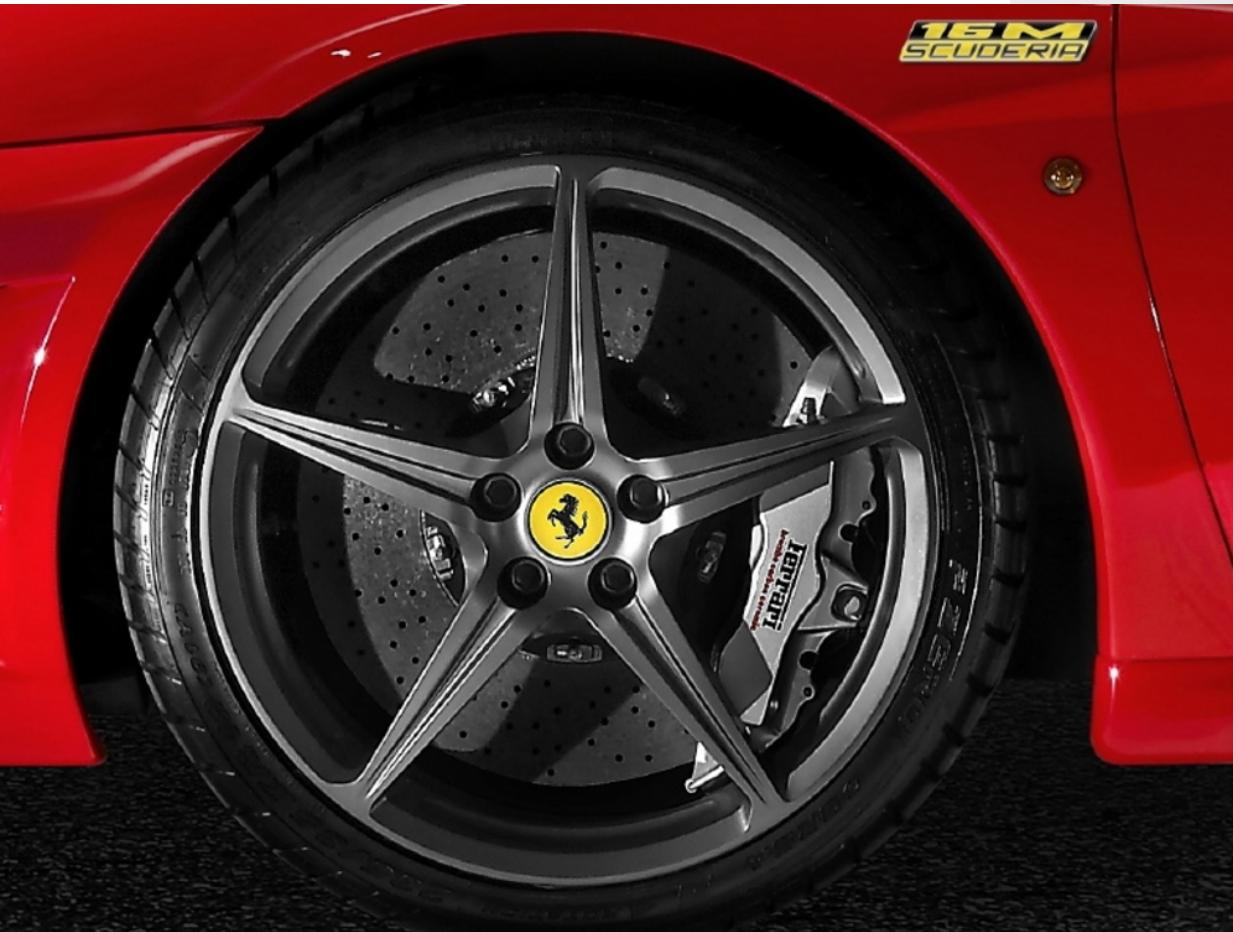
鍛造ホイールは標準仕様ホイールより 11 kg 軽量です。ばね下重量の低減はさらにダイレクトな乗り心地をもたらし、ダイナミックで過酷なドライビングスタイルにおいて、ドライバーは車のスポーツ性を存分に愉しむことができます。
