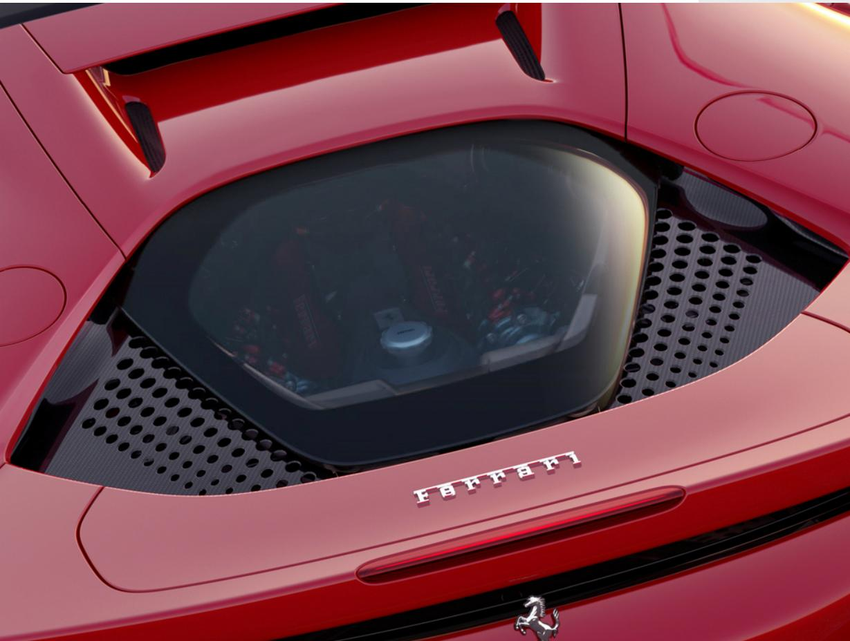
Le paratie installate nella zona terminale del lunotto posteriore garantiscono, tramite la loro particolare forma, la corretta ventilazione del vano motore.
