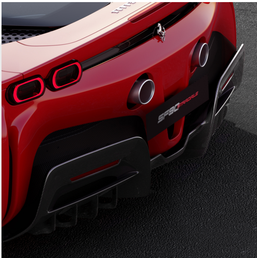
Diffusore posteriore in fibra di carbonio, per parking camera
