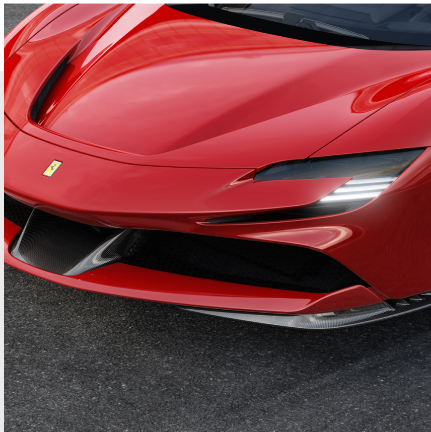
Appendici aerodinamiche anteriori in fibra di carbonio
