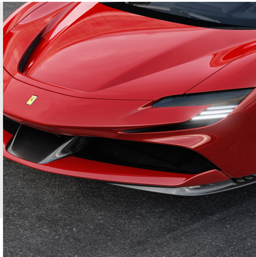
Appendici aerodinamiche anteriori in fibra di carbonio
