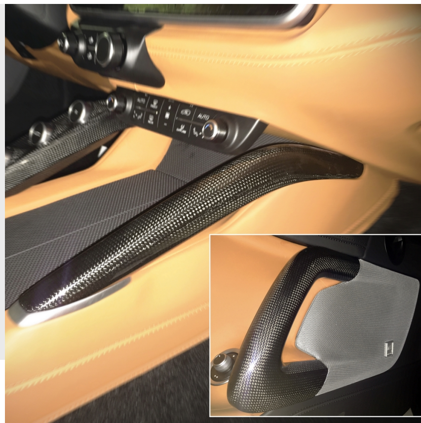
Maniglie interne in fibra di carbonio, su pannello porta e tunnel centrale
