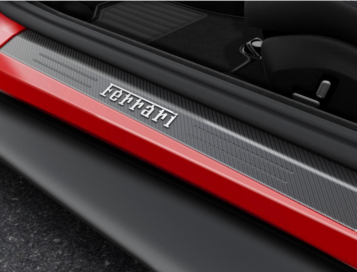
Il programma Ferrari Genuine consente di sostituire il battitacco in alluminio con una variante realizzata totalmente in fibra di carbonio. Il battitacco è impreziosito dal logo Ferrari realizzato in acciaio.
