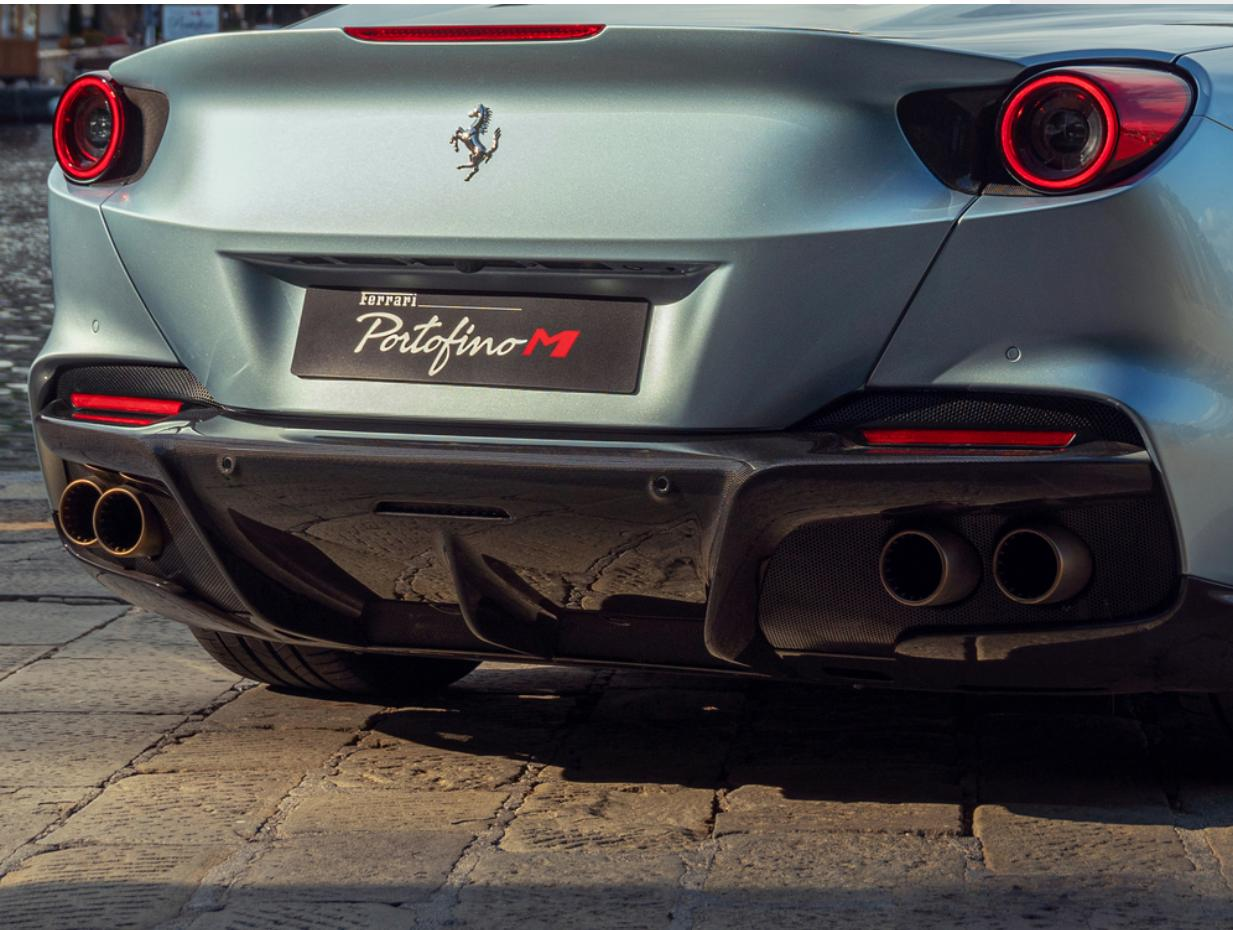
Progettato per aumentare il carico sul posteriore e favorire l'estrazione di aria dal sotto-scocca, il diffusore in fibra di carbonio esalta l'estetica della vettura e soddisfa le esigenze tecniche, contribuendo alla riduzione di peso.
