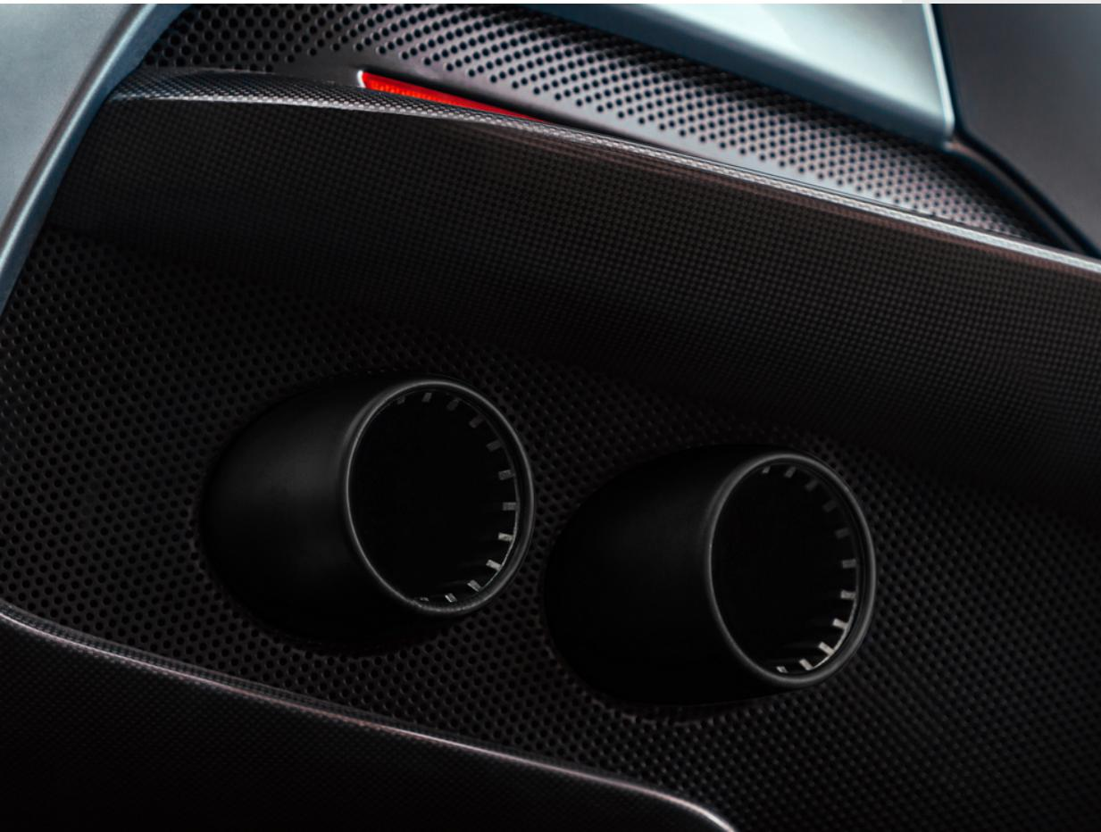
I codini di scarico in acciaio con rivestimento ceramico si contraddistinguono per l'utilizzo di materiali evoluti e trattamenti superficiali specifici, e donano alla vettura un aspetto più grintoso e sportivo. Il rivestimento ceramico permette di disperdere grandi quantità di calore, di resistere a possibili danneggiamenti incidentali e, grazie alla specifica tecnologia impiegata, di mantenere l'estetica inalterata nel tempo.
