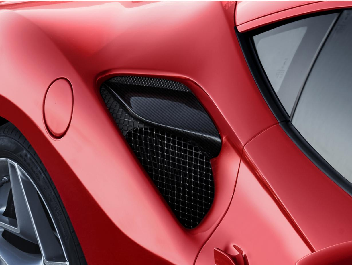
Per evidenziare degli elementi iconici come gli splitter delle prese aria laterali utili a suddividere i flussi d'aria e garantire la massima performance del motore, Ferrari Genuine propone la variante in fibra di carbonio. Questa soluzione contribuisce a ridurre il peso complessivo e ad esaltare la sportività della vettura, donandole un look grintoso e fortemente caratterizzante.
