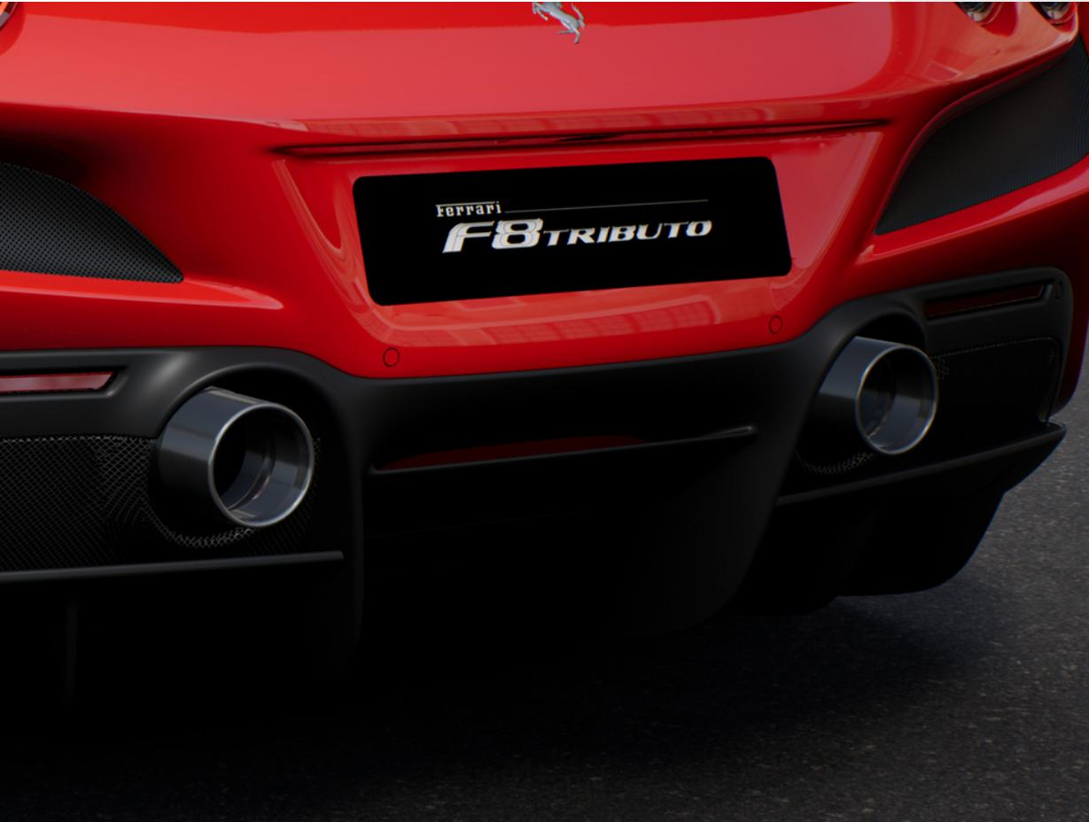
Sviluppati sulla stessa base stilistica dei terminali di serie, i codini di scarico in Titanio si contraddistinguono per una riduzione del 50% del peso e per una finitura superficiale che contribuisce a mantenere intatta l'estetica dei codini. L'impiego di questo materiale tecnologicamente evoluto garantisce la massima resistenza agli agenti esterni a dimostrazione delle continue attività di miglioramento del prodotto svolte da Ferrari.
