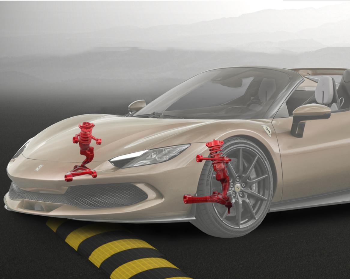
Al fine di garantire la massima praticità in qualunque situazione di guida, Ferrari Genuine propone un sistema che agevola il superamento di dossi o rampe salvaguardando l'integrità della vettura. Il sollevatore, che agisce sugli ammortizzatori della vettura, permette di sollevarla di circa 40 mm.
