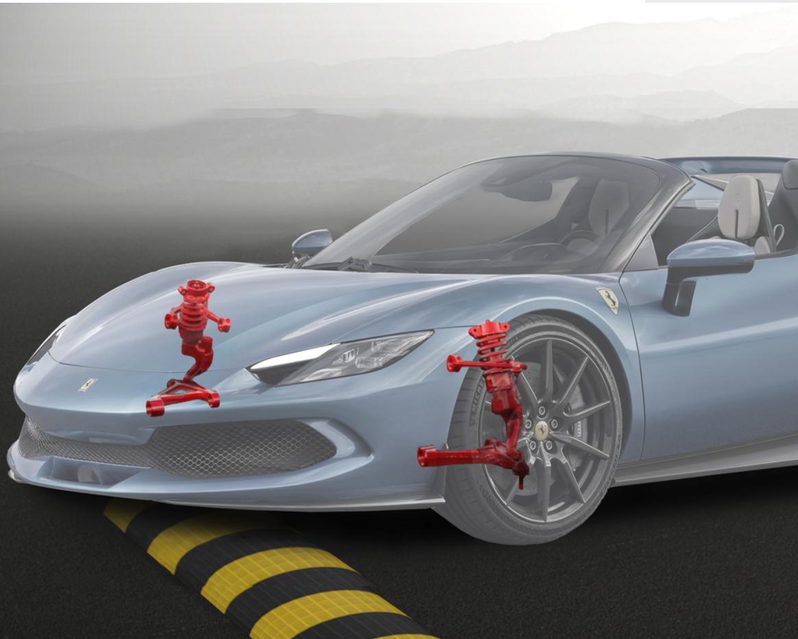
Al fine di garantire la massima praticità in qualunque situazione di guida, Ferrari Genuine propone un sistema che agevola il superamento di dossi o rampe salvaguardando l'integrità della vettura. Il sollevatore, che agisce sugli ammortizzatori della vettura, permette di sollevarla di circa 40 mm.
