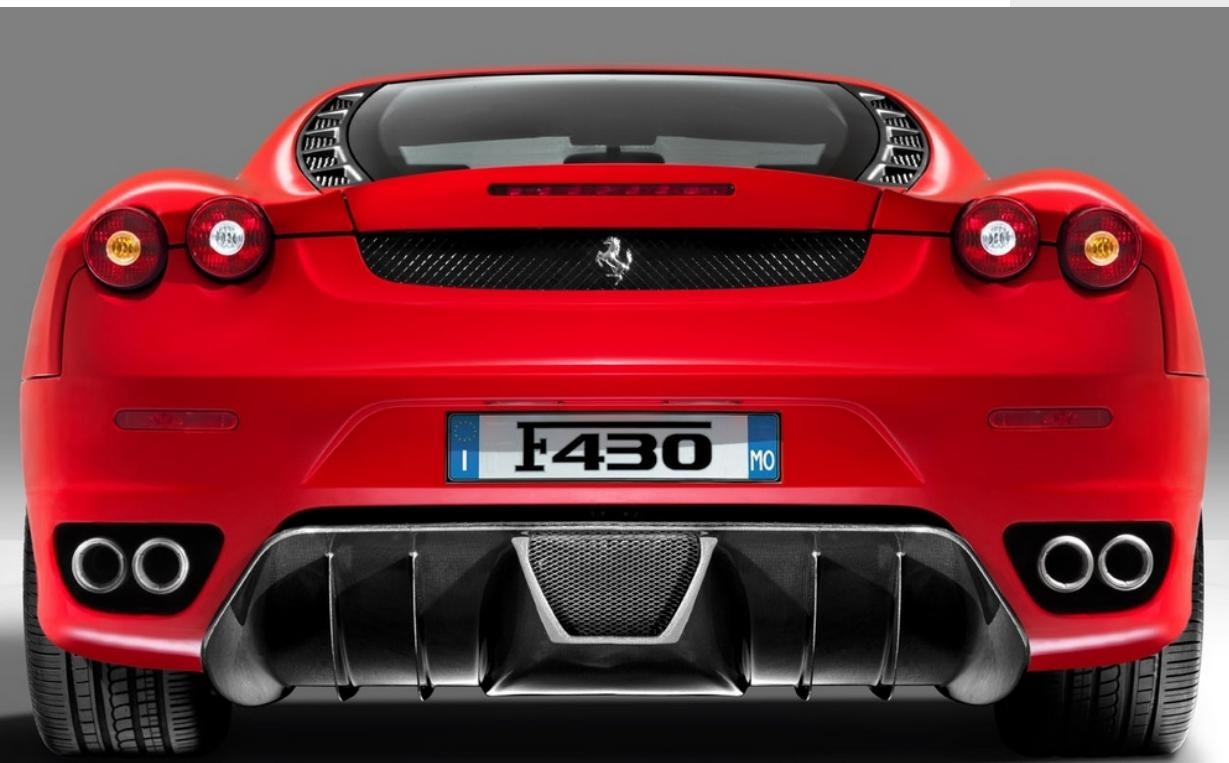
Progettato per aumentare il carico sul posteriore e favorire l'estrazione di aria dal sotto-scocca, il diffusore in fibra di carbonio esalta l'estetica della vettura e soddisfa le esigenze tecniche, contribuendo alla riduzione di peso.
