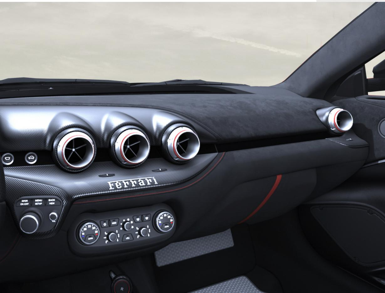
Tra i contenuti più richiesti per la configurazione degli interni delle vetture sportive, ci sono gli inserti plancia realizzati integralmente in fibra di carbonio.
