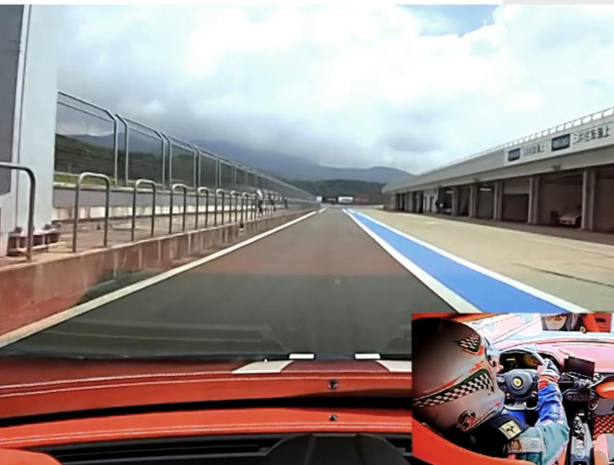
Le telecamere da pista sono un accessorio opzionale da aggiungere al kit telemetria Ferrari: installate nell'abitacolo, in modo da poter riprendere sia il tracciato della pista che la posizione di guida, permettono di registrare l'esperienza di guida e di rivedere in un video ad alta risoluzione la propria performance, analizzando le traiettorie, i punti di frenata e la tecnica di guida.
