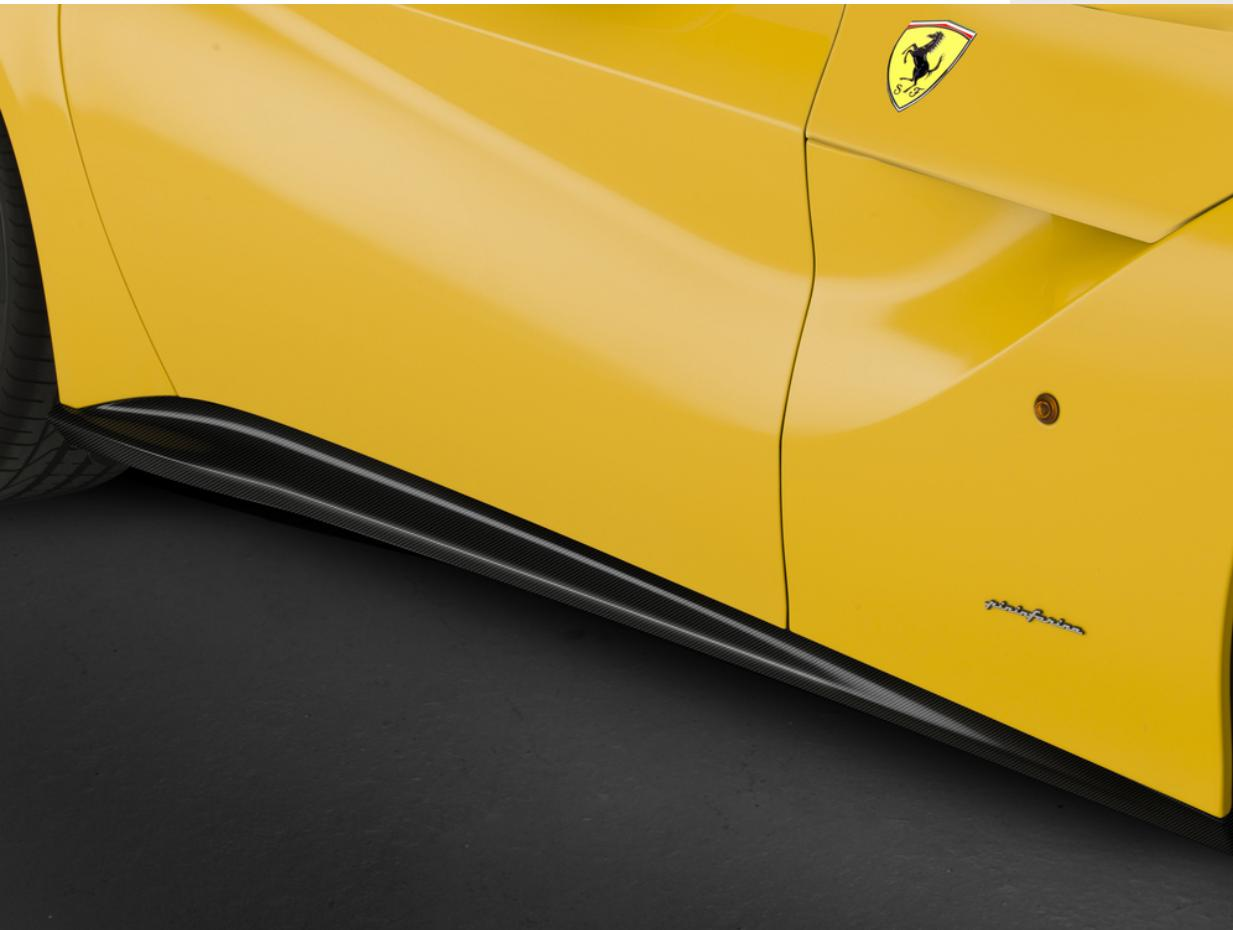
Ferrari Genuine propone di sostituire il tradizionale sotto-porta installato in vettura con il kit sotto-porta in fibra di carbonio a vista.
