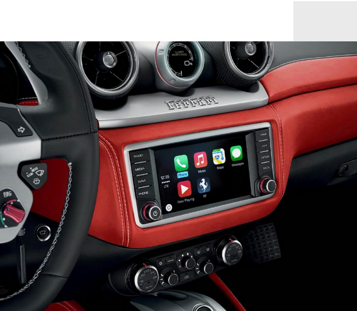
Il sistema di navigazione satellitare originale Ferrari può essere montato in post-vendita attraverso la sostituzione del NIT e l'applicazione dell'antenna GPS.
