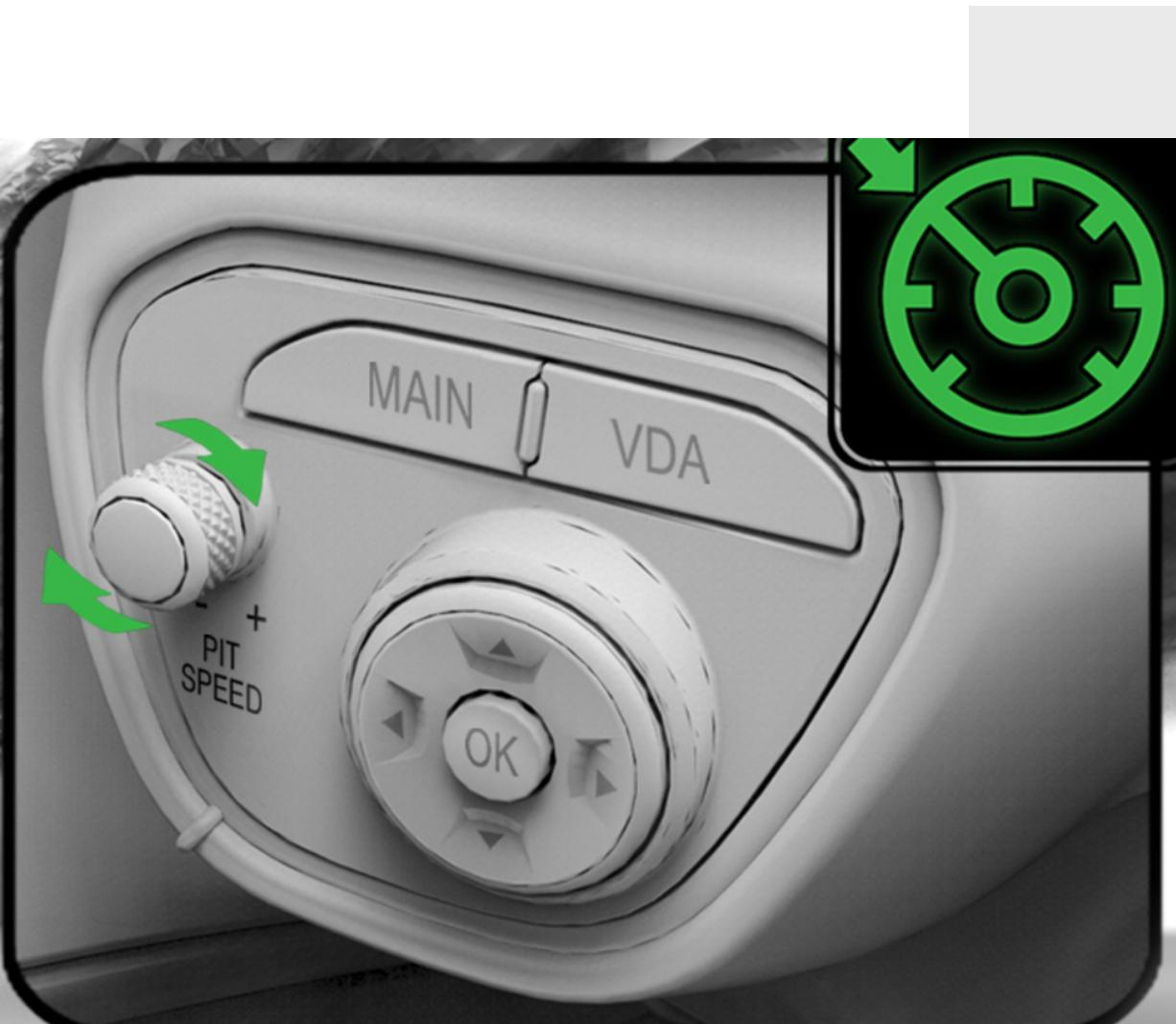
Il Cruise Control è un dispositivo elettronico che permette di mantenere una velocità costante durante lunghi tragitti autostradali.
