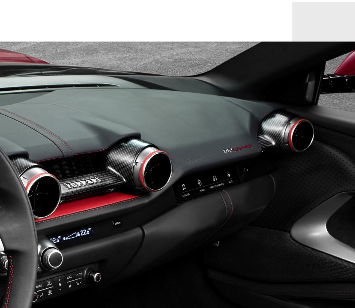
Tra i contenuti più richiesti per la configurazione degli interni delle vetture sportive, ci sono gli inserti plancia realizzati integralmente in fibra di carbonio.
