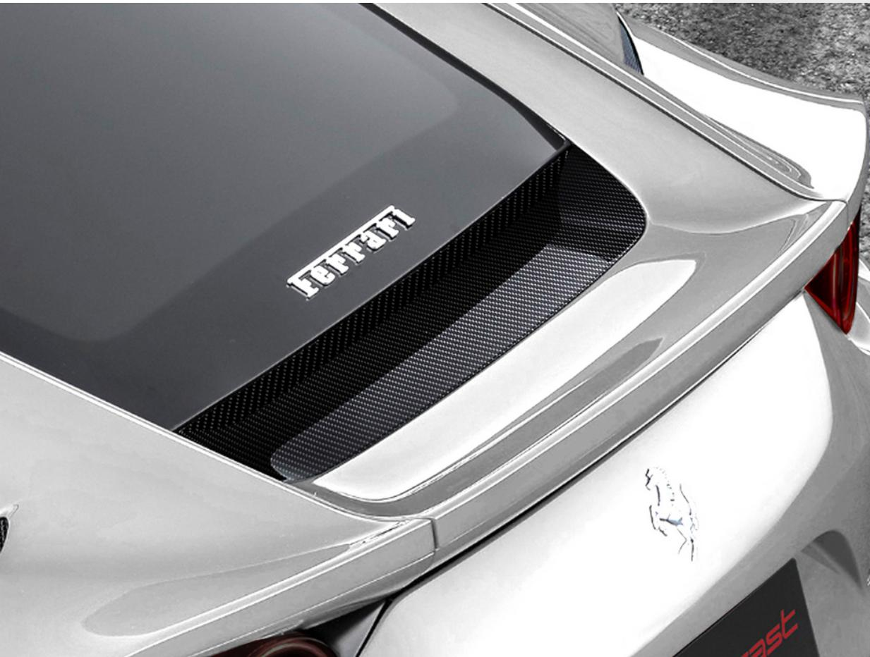
Il condotto aerodinamico posteriore presente sulla parte terminale del lunotto posteriore è un elemento fondamentale per l'aerodinamica posteriore della vettura.
