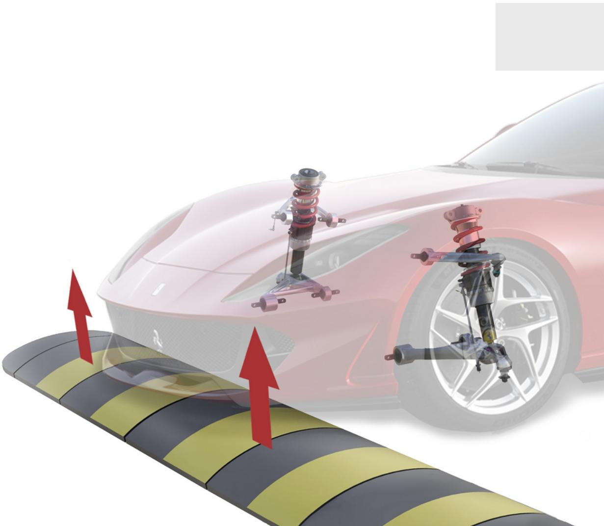
Al fine di garantire la massima praticità in qualunque situazione di guida, Ferrari Genuine propone un sistema che agevola il superamento di dossi o rampe salvaguardando l'integrità della vettura. Il sollevatore, che agisce sugli ammortizzatori della vettura, permette di sollevarla di circa 40 mm.
